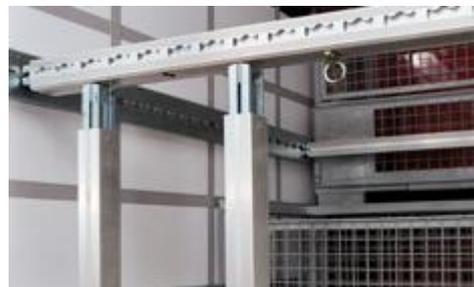
Abbildung 3: Formschlüssige Ladungssicherung
