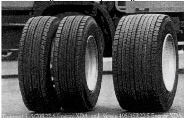
Abbildung 1: Herkömmliche Doppelbereifung (links) und Wide-Base-Single Reifen (rechts)
