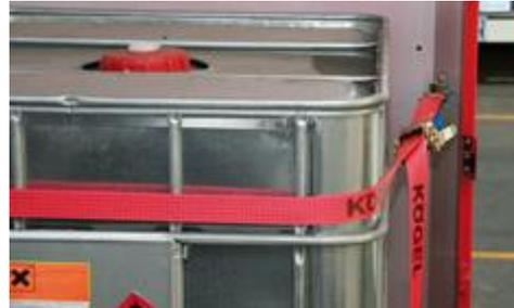
Abbildung 2: Kraftschlüssige Ladungssicherung
